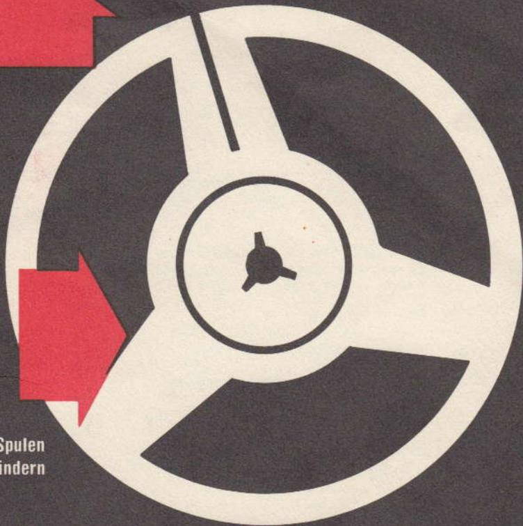
19. Spulensicherungsringe um eine Lösung der Spulen während des senkrechten Betriebes zu verhindern
